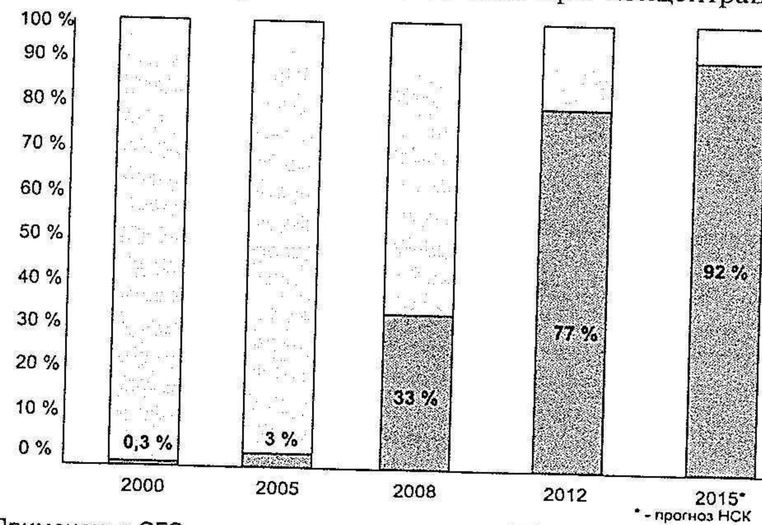
Применение СГО в производстве газобетона: □ – ПАП, ■ – СГО
